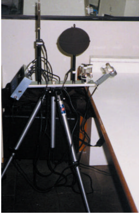
Foto 3: Equipamento de medição de variáveis ambientais BABUC-A
