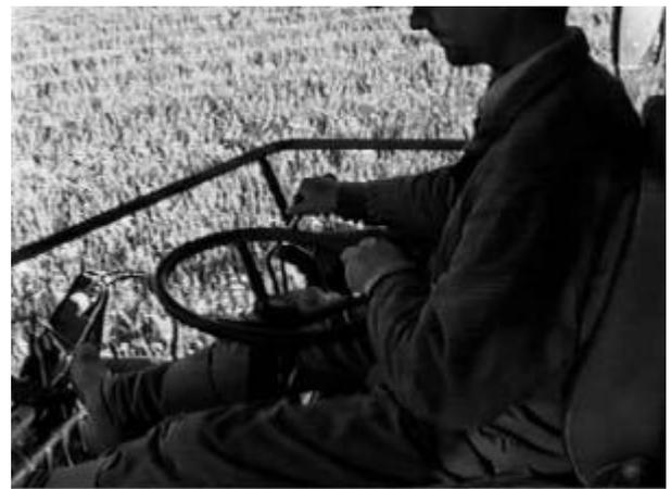
Figura 5 – Flexão frontal de pescoço do operador quando da visualização da plataforma de colheita.
