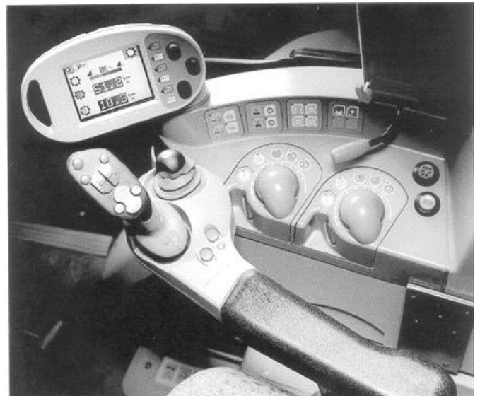
Figura 10 – Direção hidráulica de um trator por meio de um controle em forma de um joystick (KUTZBACH, 2000 – p. 245).
